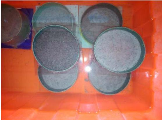
圖 4-1 再生混凝土之養護情形
