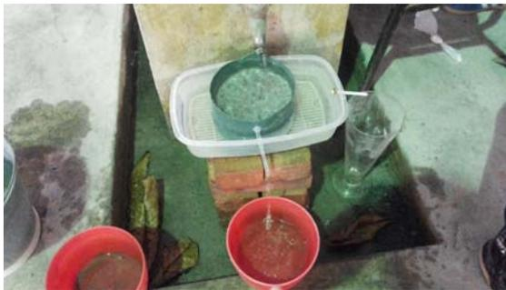
圖 4-2 再生混凝土磚之透水性試驗
